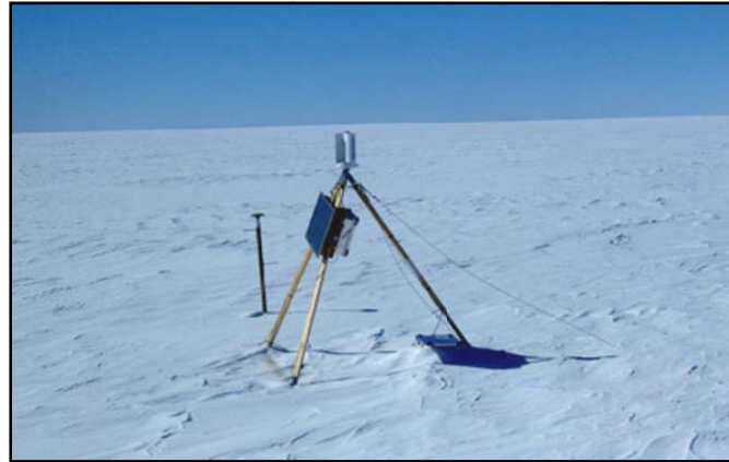
Figure 4 : Pyramide GPS située d'un côté de la crevasse sur le glacier, Source : Laurent Testut
