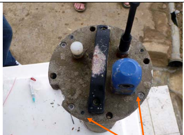
Les orifices des vis et filetages sont remplis de graisses silicone pour éviter le dépôt calco-magnésien
