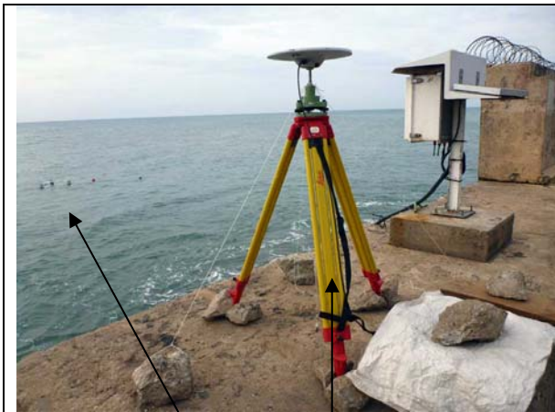
Bouée GPS et Station de Base sur SAO 3
