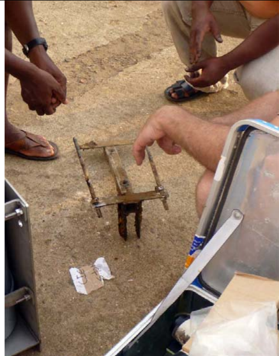
Etat du marégraphe après un séjour de 7 mois dans l'eau et de l'ancien support.
