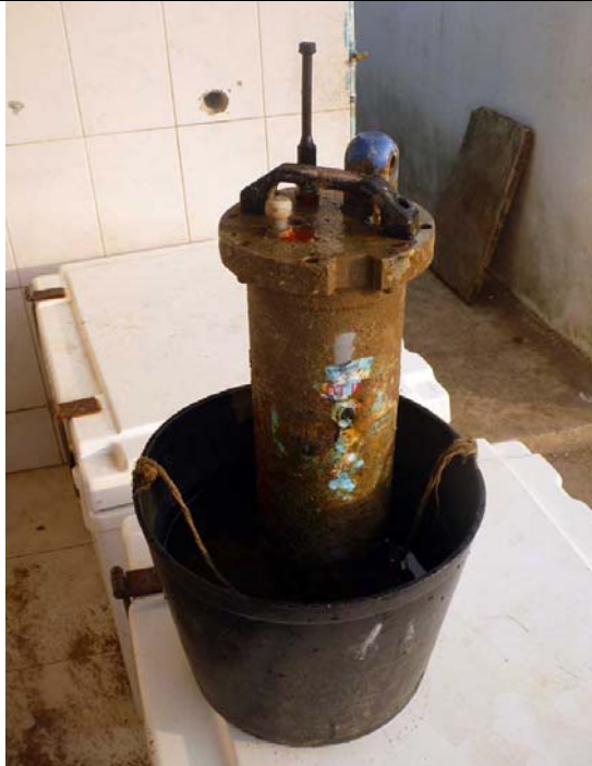
Etat du marégraphe après un séjour de 7 mois dans l'eau et de l'ancien support.
