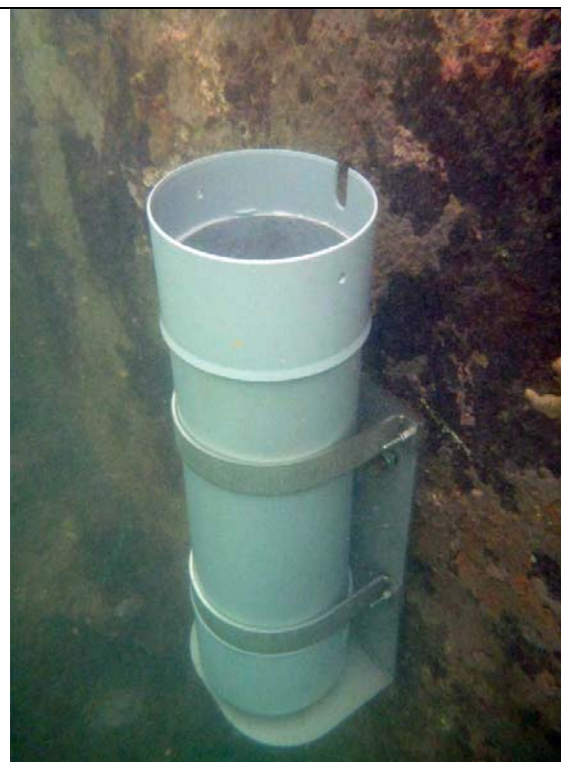
Le tube qui accueille le marégraphe est en place
