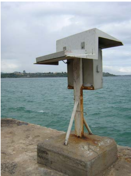
Photos 9 : Balise Argos du marégraphe. Support rouillé, et consolidation de fortune effectuée avec une corde (à droite).
