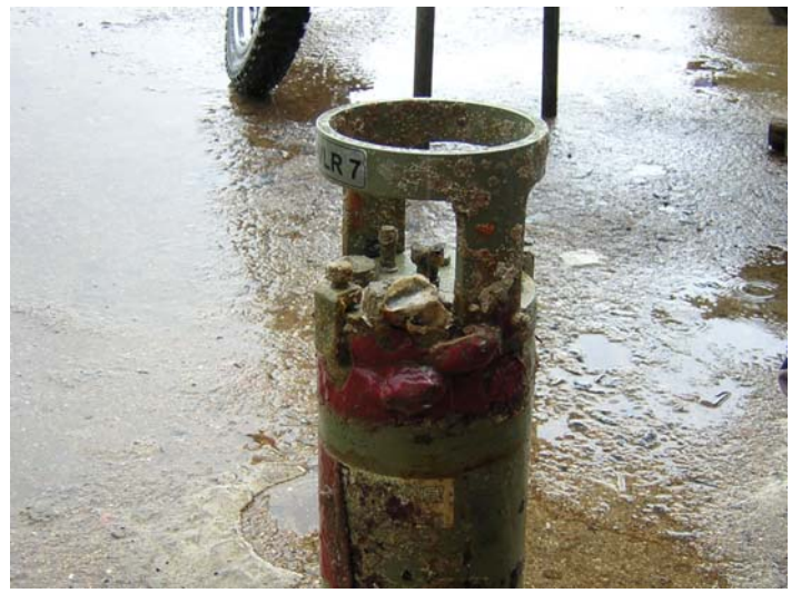
Photos 1 : Marégraphe « autonome » tel qu'il a été relevé le 10 octobre 2003, moins d'un an après son installation.
