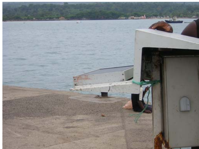
Photos 9 : Balise Argos du marégraphe. Support rouillé, et consolidation de fortune effectuée avec une corde (à droite).
