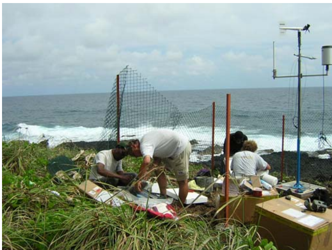
Photos 6 : Installation du grillage de protection et de la station météorologique.
