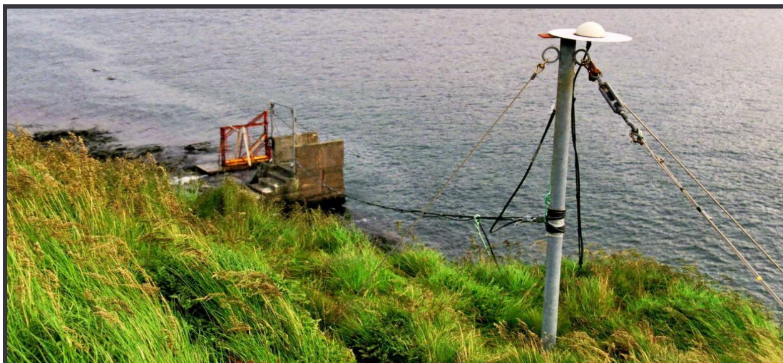
Figure 16 : Le marégraphe de Crozet : au premier plan l'antenne Argos.
