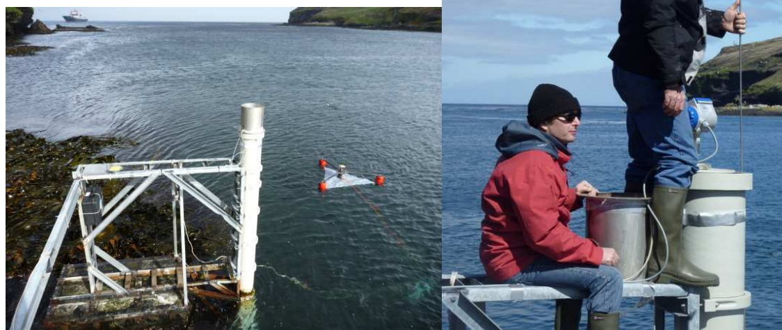
Figure 2 : Tube marégraphique et session bouée GPS à Crozet. Maintenance du radar (c'est la joie !)
