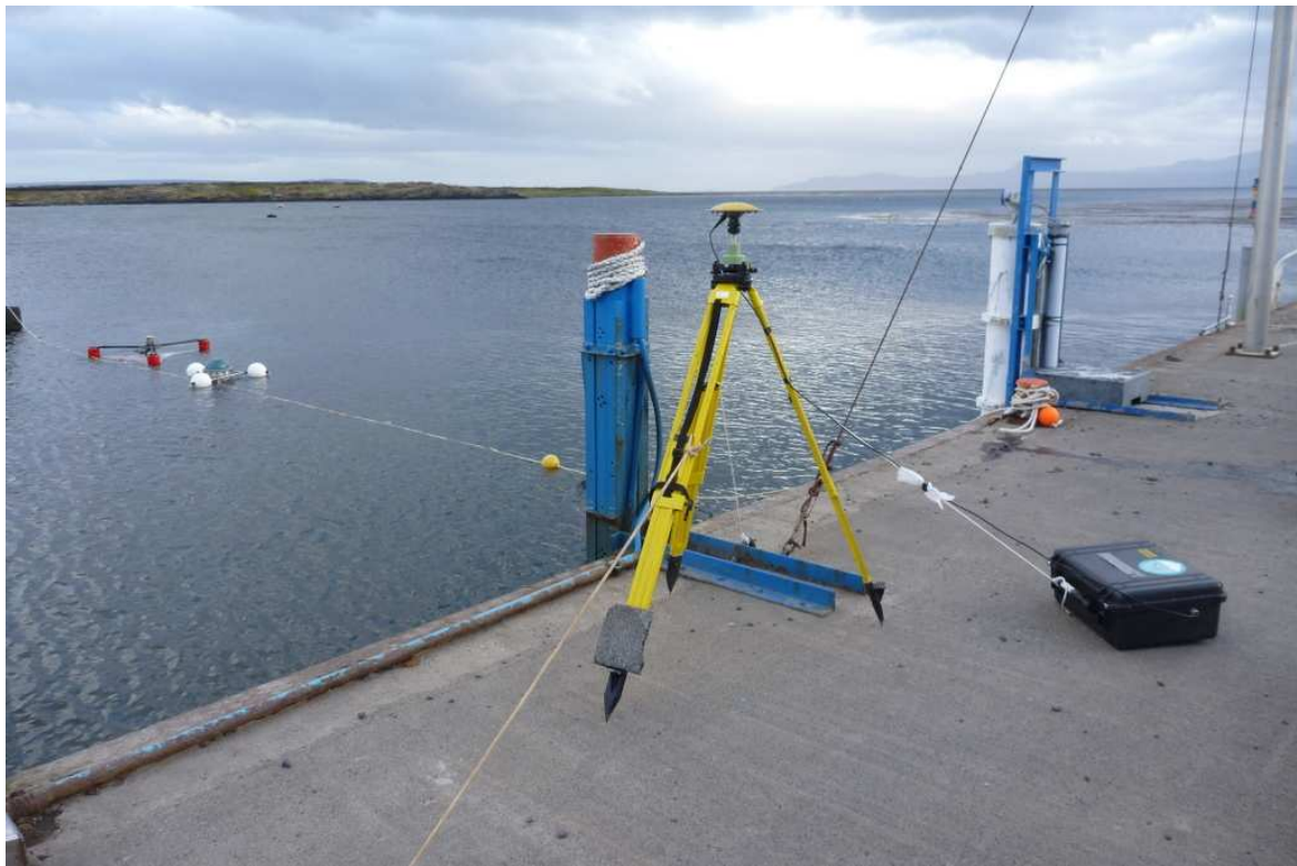
Figure 4 : Session bouées GPS à Kerguelen avec trépied sur le repère F (du 14/12 au 15/12)
