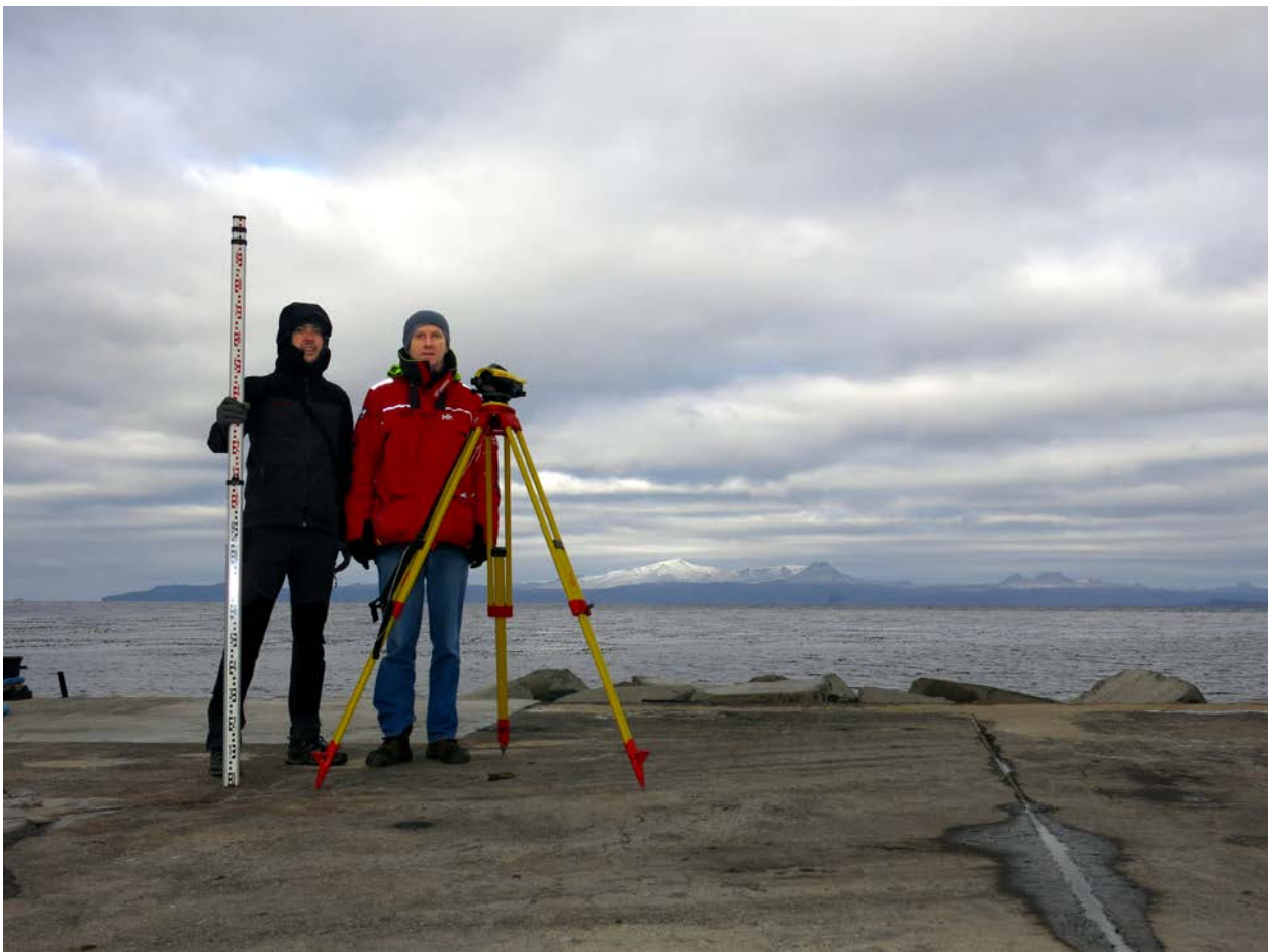
Nivellement des repères de l'observatoire marégraphique à Port aux Français.
