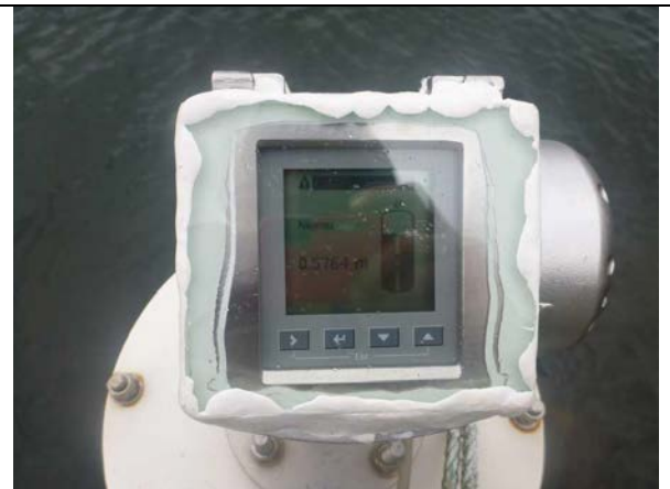
Le nouveau radar indique un tirant d'eau de 0,576m sur une tige d'une longueur de 2.5m.
