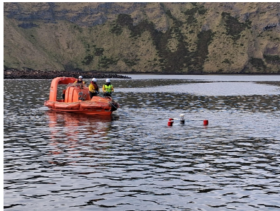
Tractage de la bouée GNSS par le Workboat et dépôt de mouillage
