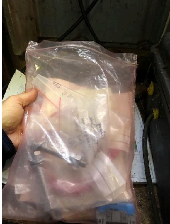
Figure 43 Contient un sac avec divers accessoires : - des bouchons pour les stations et les câbles - des vis pour la fermeture du tube marégraphique - écrous et contre écrous pour la tige radar
