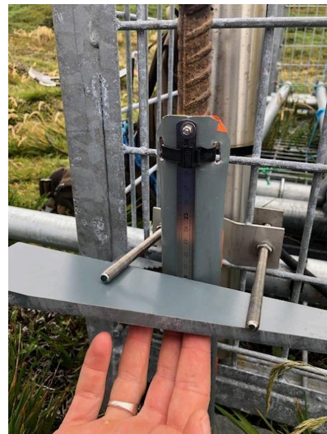
Figure 16 La lecture se fait sur le réglet, ici 200mm
