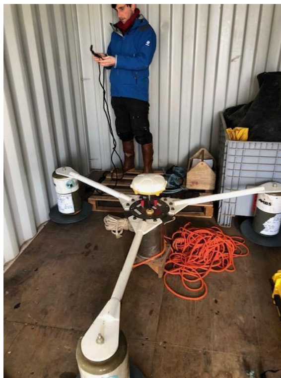
Figure 19 Les bras réparés ont été remplacés
