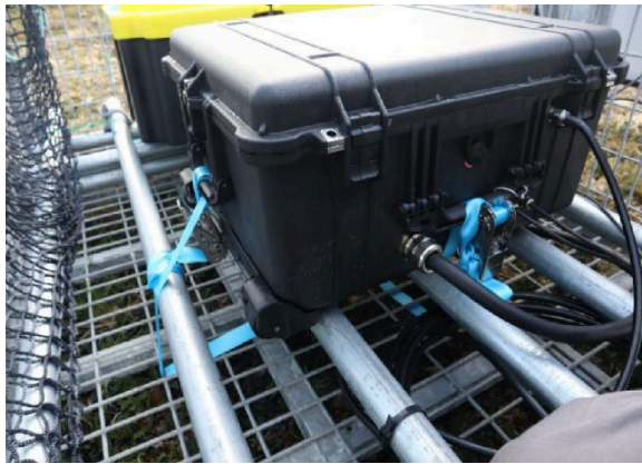
Figure 14 Fixations Pelicase et caisse batterie
