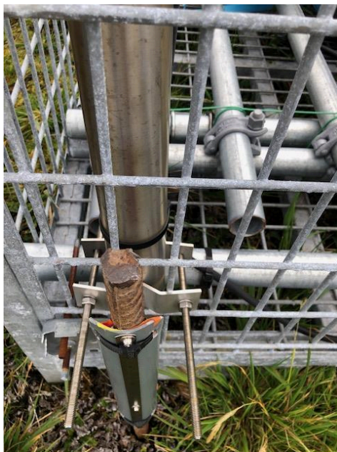
Figure 15 Réglet fixé sur fer à béton devant le mat
