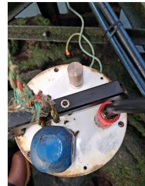
Figure 33 Mise en place du filtre après appoint d'huile
