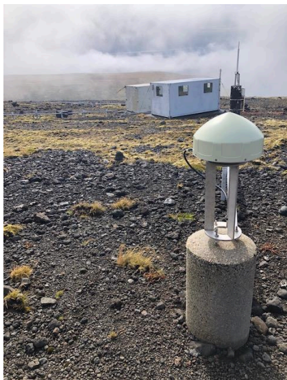
Figure 5 Pilier et antenne CZTG
