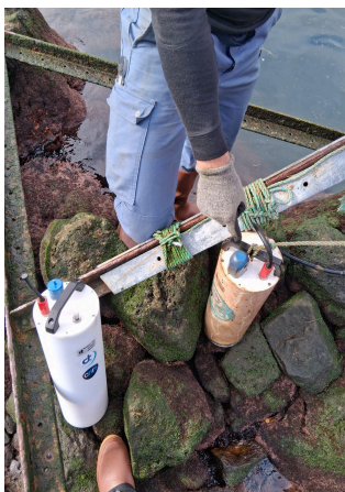
Figure 35 Marégraphe de rechange à gauche, marégraphe déjà sur place et finalement remis à l'eau à droite
