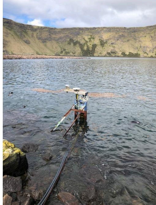
Figure 40 La structure marégraphe à marée montante
