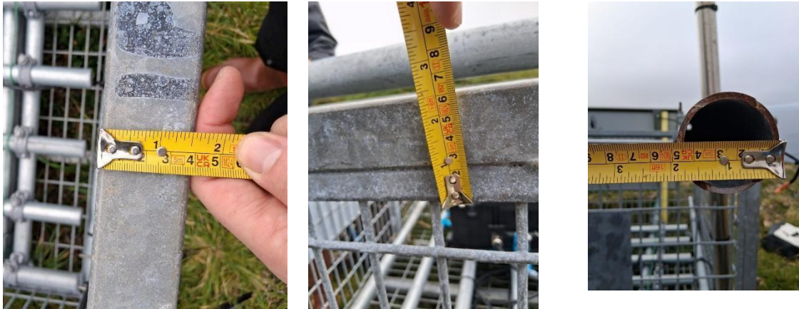
Figure 10 Dimensions de la structure du cadre de la cage
