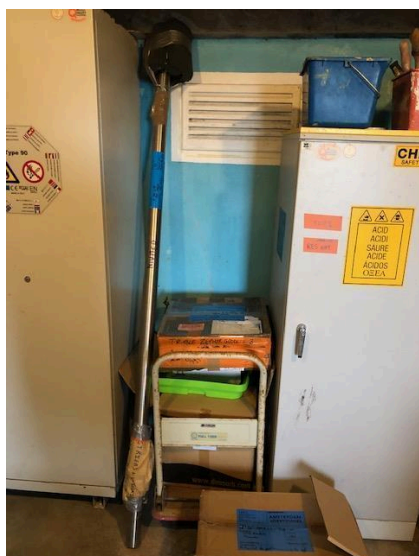
Figure 50 Mat en acier inoxydable H 200mm, Diamètre 60mm, 11kg
