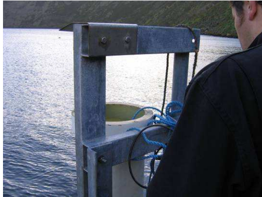
Vue de la plaque support d'antenne GPS pliée
