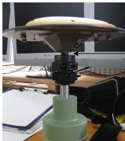
Vue montrant le défaut de vissage de l'antenne sur l'adaptateur
