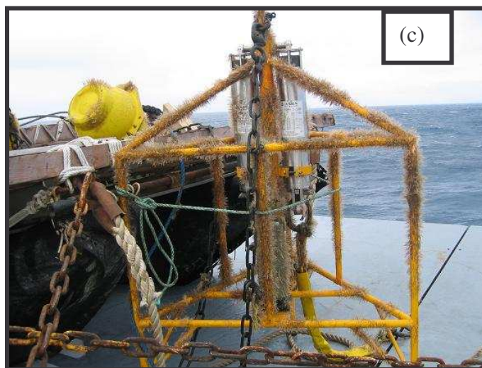
Figure 7: (a) Repérage du marégraphe au sondeur. (b) Récupération du mouillage CRO04. (c) Etat du mouillage CRO04.
