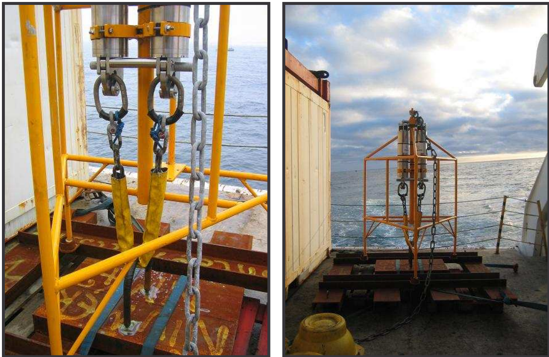
Figure 17 : Mouillage AMS05 monté (voir protections autour de la chaîne à cause de l'oxydation)
