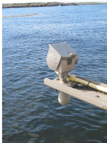
Figure 14 : Marégraphe radar PAF
