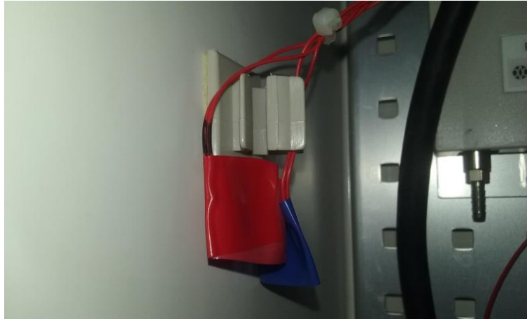
Figure 10: alimentation émetteur ARGOS
