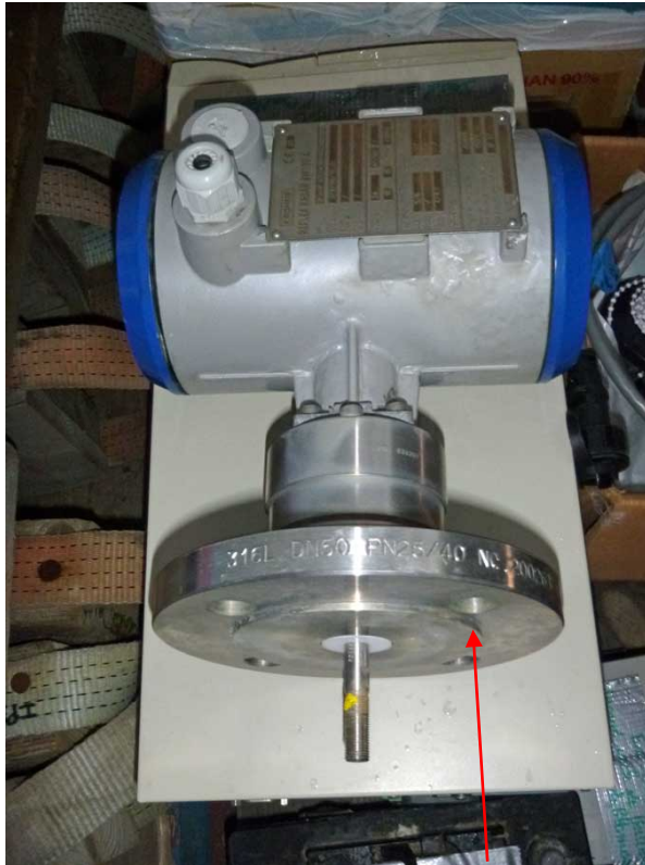
Ancien radar BM100A de KER2. Décrochement.
