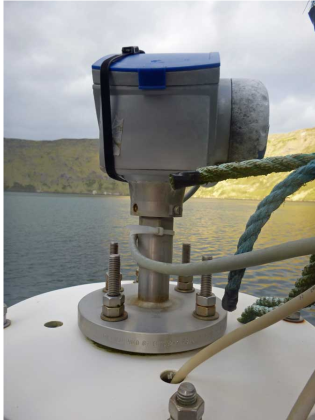
Le radar est 6mm au-dessus du tube marégraphique
