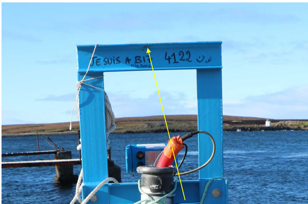
Nivellement du point de fixation d'une antenne GPS sur le haut de la structure de KER2
