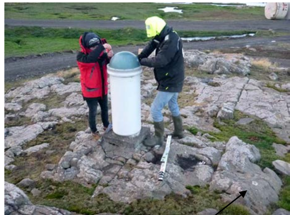
Remontage du dôme après nivellement par rapport au repère L
