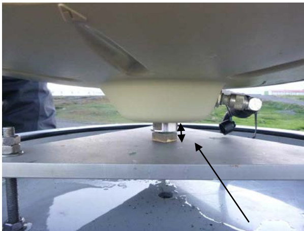
Hauteur ARP-Dessus du Triangle mesurée=20mm
