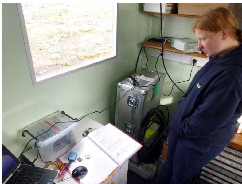
Connexion pour mise à jour du gps Leica GR25 de Crozet.
