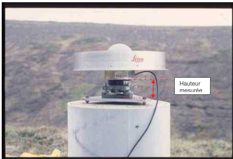
Figure 10 : Montage de l'antenne GPS sur le pilier géodésique.
