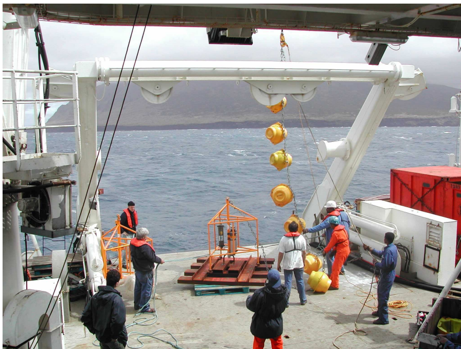
Figure 7 : mouillage du marégraphe AMS03
