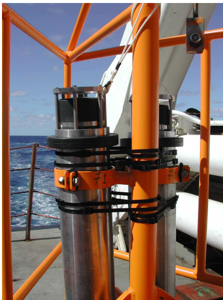
Figure 1 : Situation des deux largueurs dans la cage du marégraphe et du U d'attache du lest avant mouillage.
