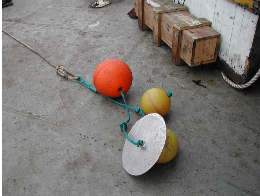
Figure 6 : détail de la coupelle métallique insérée sur la ligne de flotteurs du marégraphe AMS03 mouillé à Amsterdam.
