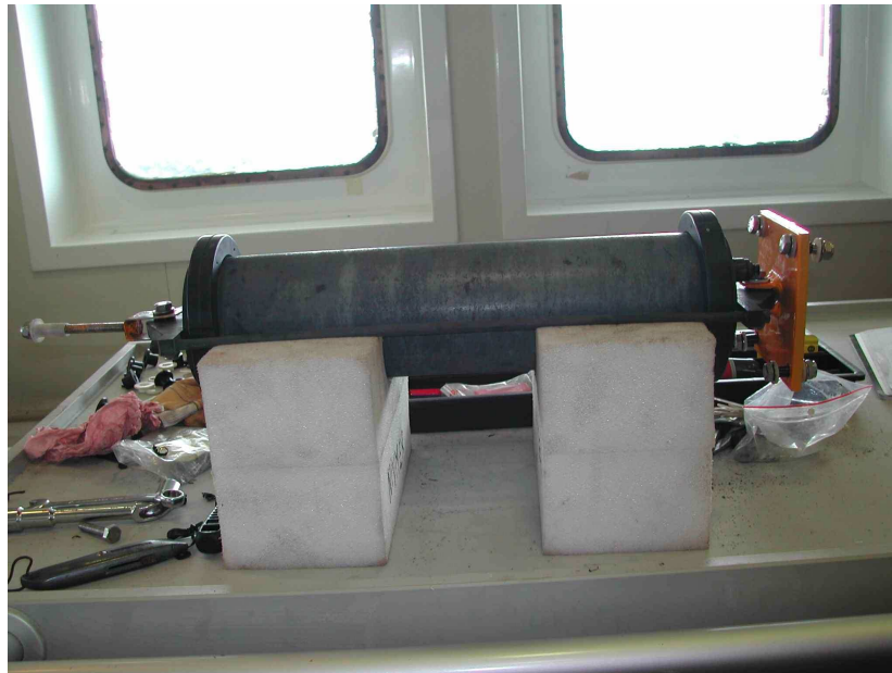
Figure 3 : Préparation d'un marégraphe Mors de type OT310.
