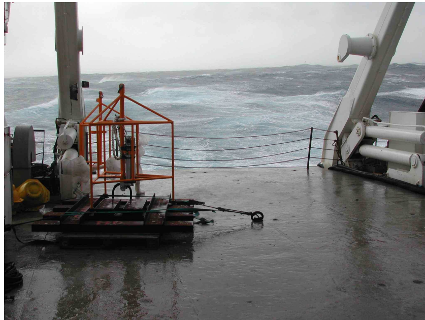
Figure 4 : Cage Marégraphique prête sur la plage arrière du MDII sur fond de tempête
