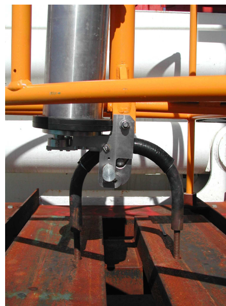
Figure 1 : Situation des deux largueurs dans la cage du marégraphe et du U d'attache du lest avant mouillage.
