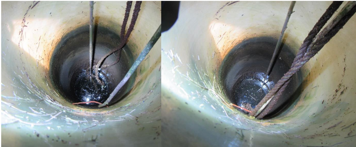
Figure 3 : Démêlage de la corde sur la tige de guidage, AVANT/APRES.
