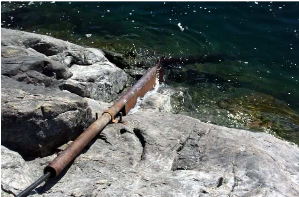
Figure 3: Tube du marégraphe pour le passage de la "banquette"
