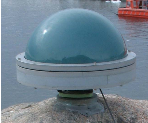
Ancien support d'antenne fixe
