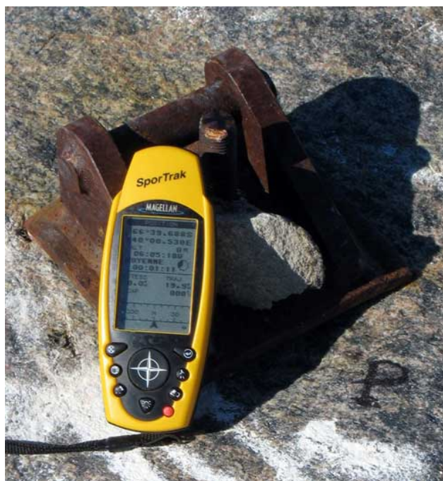
Repère intermédiaire P pour niveler entre N et M Position : 66°39.769'S / 140°00.531'E
