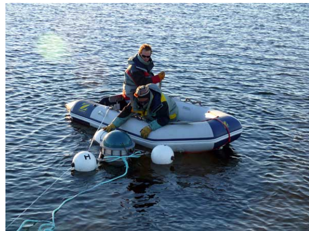
Mise à l'eau de la bouée GPS et lecture de la hauteur sur les réglets ©A. Desautez - IPEV
