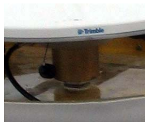
Réhaussement de l'antenne de la bouée GPS par une pièce cylindrique en laiton de 37.2mm
