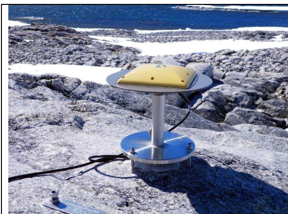
Antenne sur repère AUS2002
