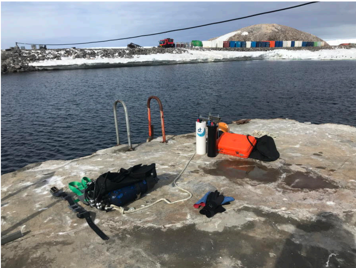
Les marégraphes station et autonome sont prêts pour leur mise à l'eau
