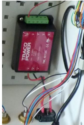
Nouveau transformateur 220V/12V
