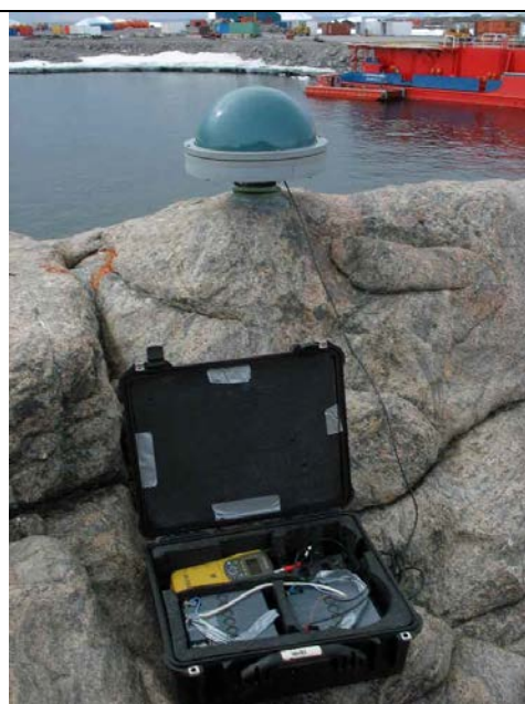
Station de Base (01/2009) Rem : Il manque l'embase Leica (voir p18).
