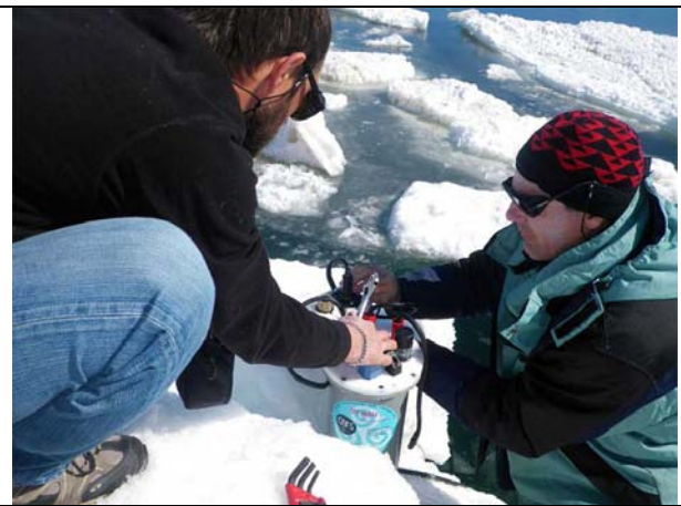
Préparation du nouveau marégraphe
