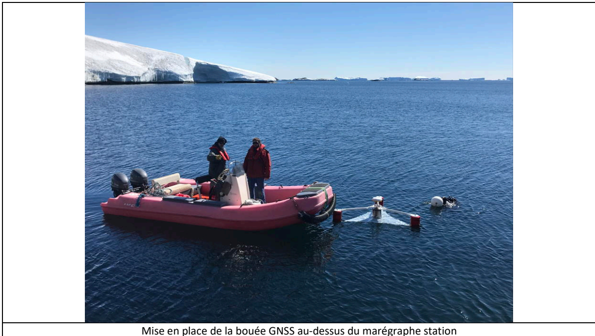
Mise en place de la bouée GNSS au-dessus du marégraphe station
