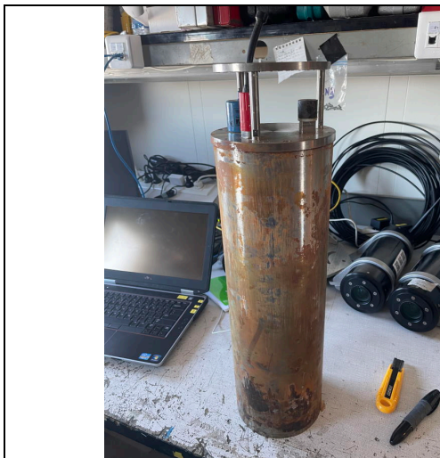
L'ancien marégraphe en Titane recouvert d'oxyde de fer de la chemise de calage...
