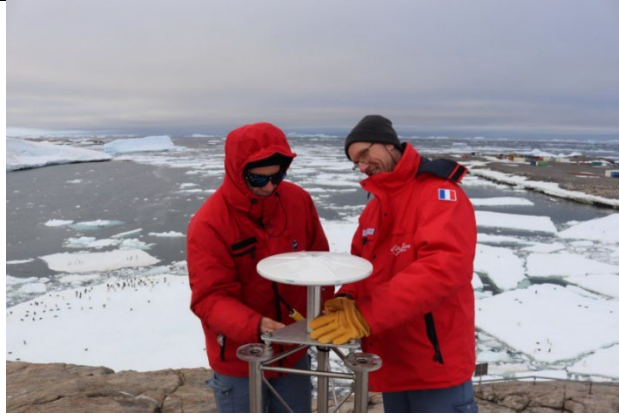
Mise en place de l'antenne GNSS
