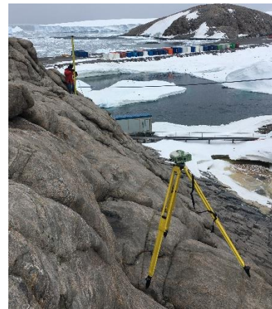
Figure 5 : Réalisation du nivellement
