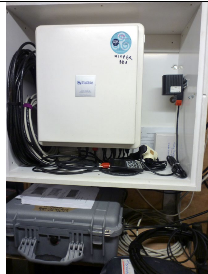
Le récepteur GNSS DUM R est dans la valise grise, sous la station.
