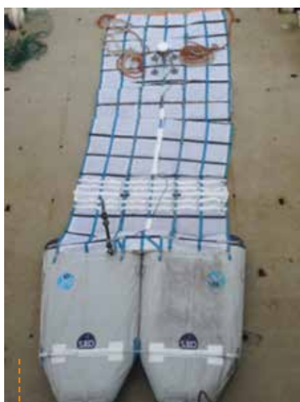
Figure 6 - La nappe instrumentée (à gauche) et la route suivie par le Marion Dufresne lors de son tractage.
