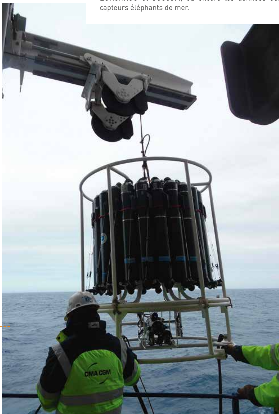
Figure 4 - Déploiement de la CTD sur le pont du Marion Dufresne .
