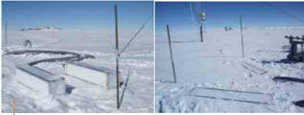
Dispositif de chambre à flux avant (gauche) et après (droite) son enfouissement dans la neige de Dôme C. Il permet de mesurer les émissions des oxydes d'azote par la neige en conditions contrôlées. En arrière plan, la station Concordia (©J. Savarino).
