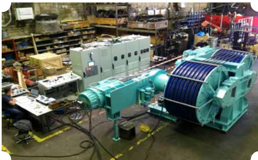
Figure 5 : Le nouveau treuil du Marion-Dufresne lors de la recette en usine
