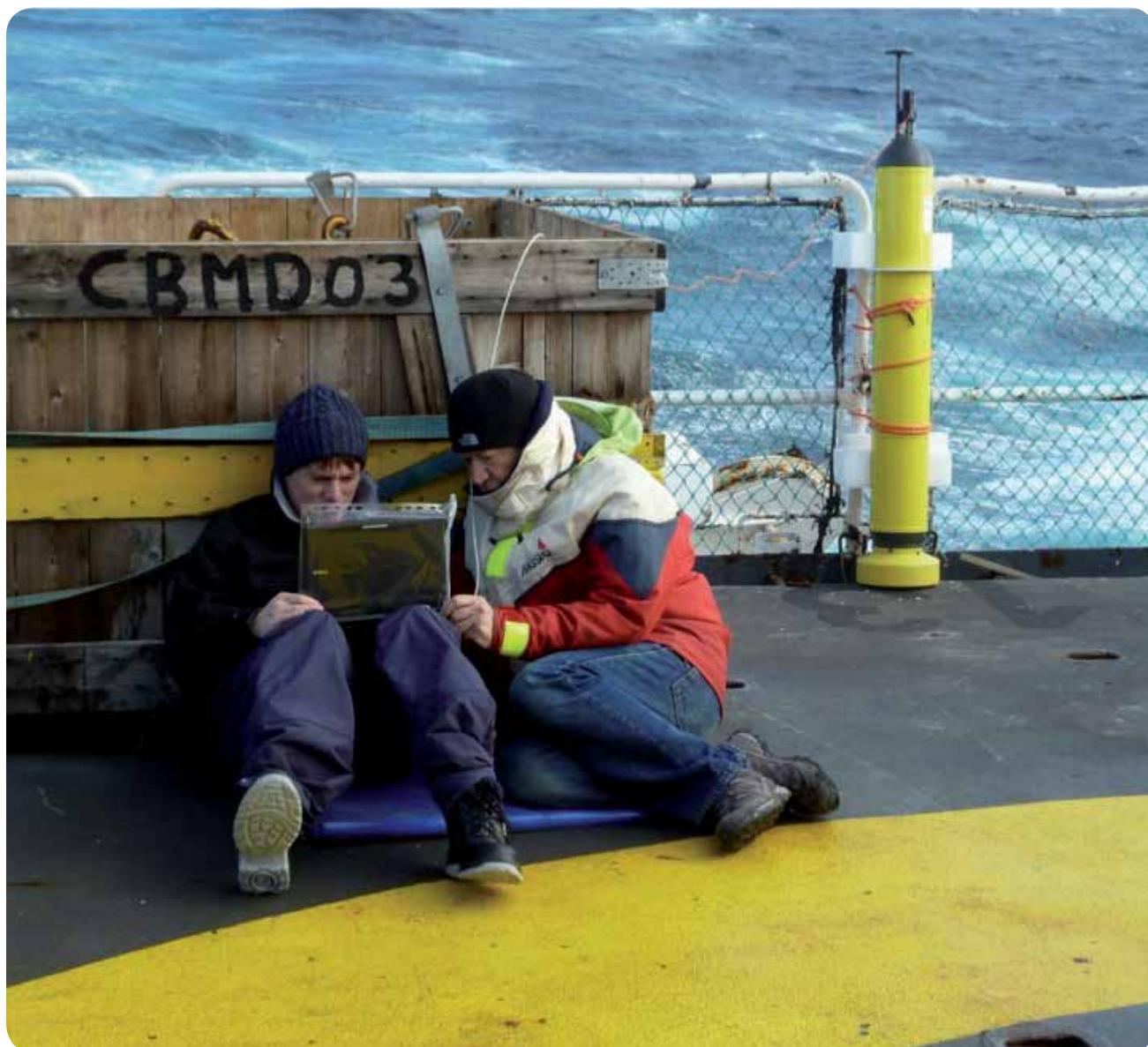
Préparation d'une bouée de type MERMAID au cours de la mission MD 193 / LOGIPEV.
