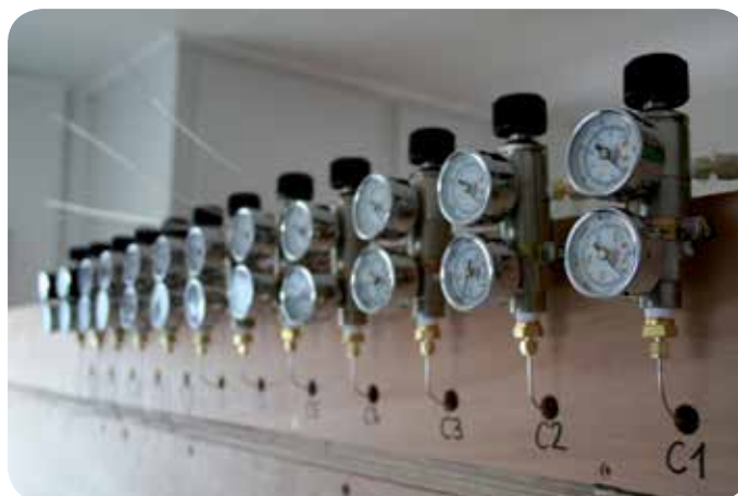
Figure 4 : Manomètres permettant le réglage des flux d'air des cylindres de références et de calibration pour l'analyseur \text{O}_2/\text{N}_2 . Pas moins de 16 cylindres (dont 4 en secours) sont utilisés pour le bon fonctionnement annuel de cet analyseur (photo M. Delmotte, LSCE)
