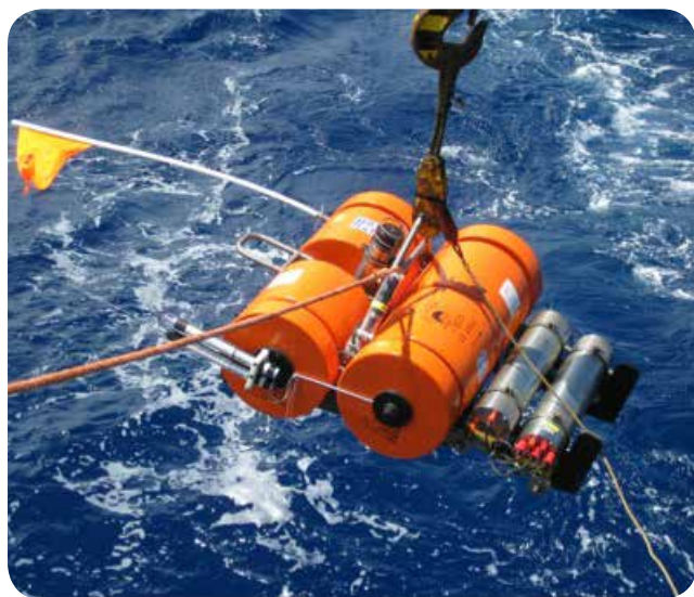
Figure 4 : Déploiement d'une station sismologique de fond de mer au cours de la campagne MD 192/RHUM-RUM.
