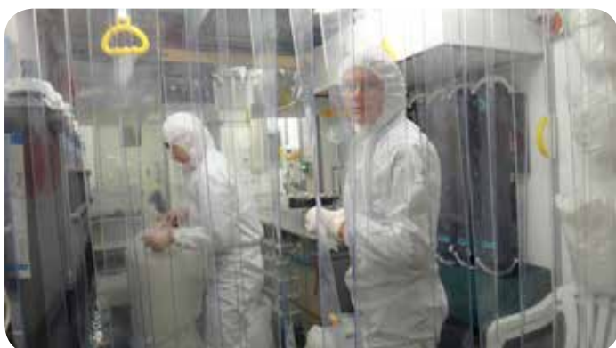
Vue de l'intérieur du container propre pour le prélèvement des échantillons destinés à l'analyse des concentrations en fer. Inside of the trace metal clean container.
