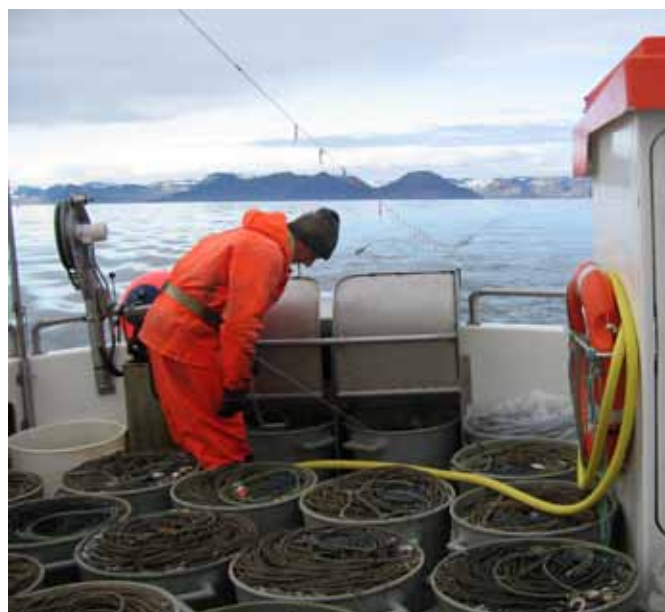
Cuves à bord d'un palangrier. Chaque cuve contient une section de filière comprenant 500 hameçons. Deux hommes embarquent entre 24 et 36 cuves. © Mariat-Roy E.
