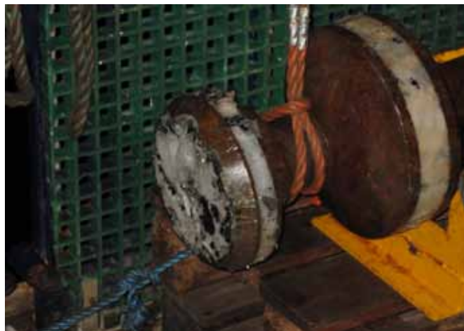
Tête du "wax core", de retour sur le pont. On distingue des petits morceaux de verre noir (silicate fondu) dans la cire (blanche) arrachés au plancher océanique.
