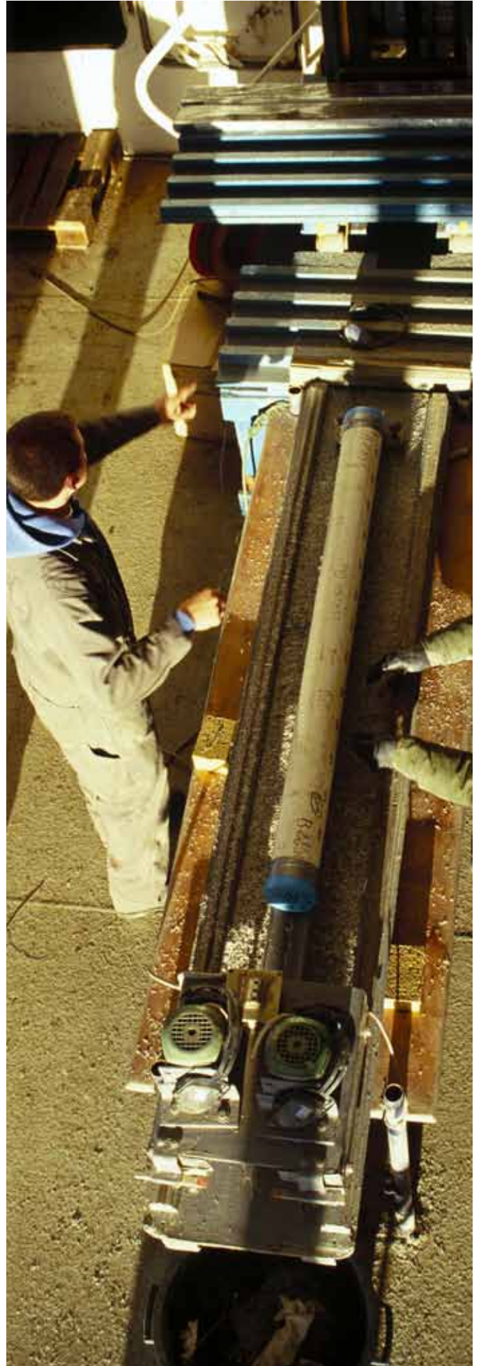
Ouverture des sections de carottes sédimentaires sur le pont
