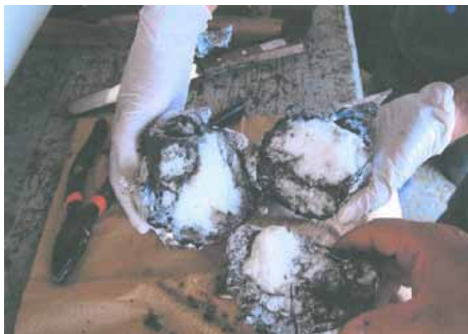
Gros blocs d'hydrates de gaz extraits au cours de la mission MD179 JAPAN SEA GAZ HYDRATE.
