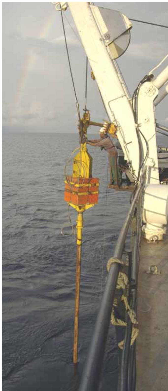
Carottage de type Calypso effectué au cours de la mission MONOCIR leg 2.
