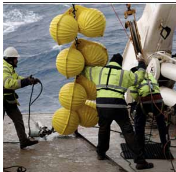
VT I 10 : Récupération d'un courantomètre grand fond par mauvais temps.
