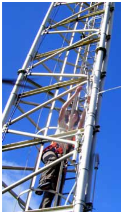
Figure 4 : Collecte des aérosols marins sur le pylône de la station de "Pointe Bénédicte" à l'île Amsterdam. Les échantillons aérosols sont collectés par filtration et envoyés au LSCE (Gif/Yvette, France) pour l'analyse de leur composition chimique par classes de taille. © Chapuis S.
