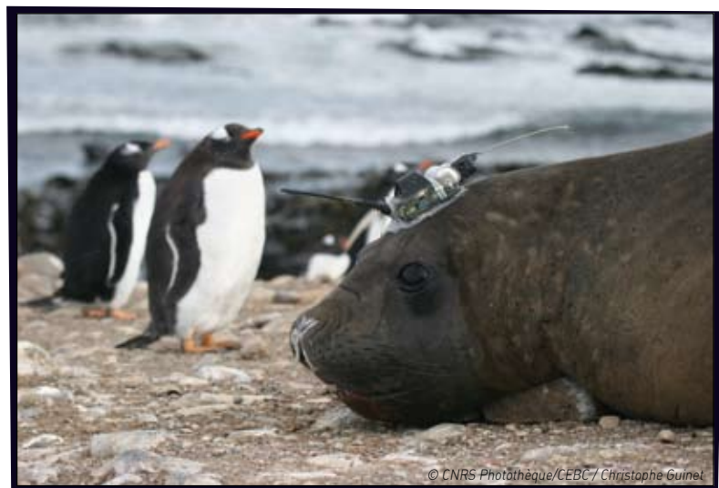
Femelle éléphant de mer « Mirounga leonina » prête à partir en mer. Elle est équipée d'une balise Argos munie de capteurs de pression, température, salinité. Un émetteur VHF est collé à l'arrière de la balise, ce qui permet de retrouver environ 30 % des balises déployées et qui se détachent naturellement au cours de la mue, un an après la pose. Îles Kerguelen au sud de l'océan Indien. Les éléphants de mer qui passent la plus grande partie de leur vie en pleine mer, effectuent des plongées pouvant aller jusqu'à 2 000 mètres de profondeur. Equipés de ces balises, ils constituent pour les chercheurs une source d'informations sur l'océan Austral (climat, courants marins, échanges océan-atmosphère et production primaire).
