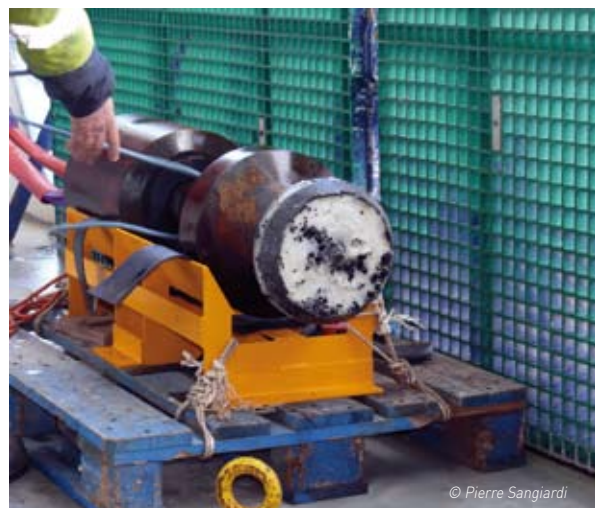
Campagne GEISEIR. Echantillons de basalte récupérés à l'aide du carottier à cire.
