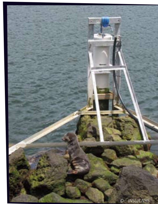
Le marégraphe installé en 1994 à Saint-Paul dans le cadre du programme NIVMER.
