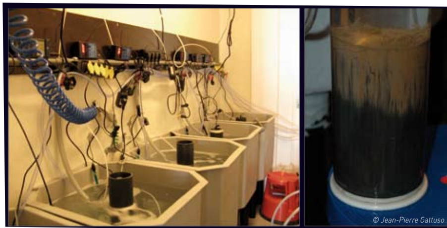
Système de régulation de la p\text{CO}_2 dans les bacs alimentant les carottes sédimentaires.
