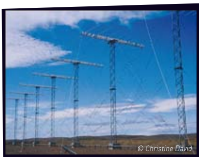
Radars ionosphériques SuperDARN à Kerguelen, pour l'étude des interactions Terre-Soleil.
