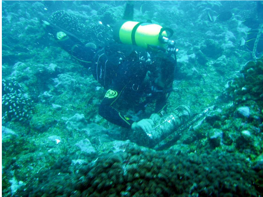
Récupération du marégraphe Côtier ©L.CHARPY IRD
