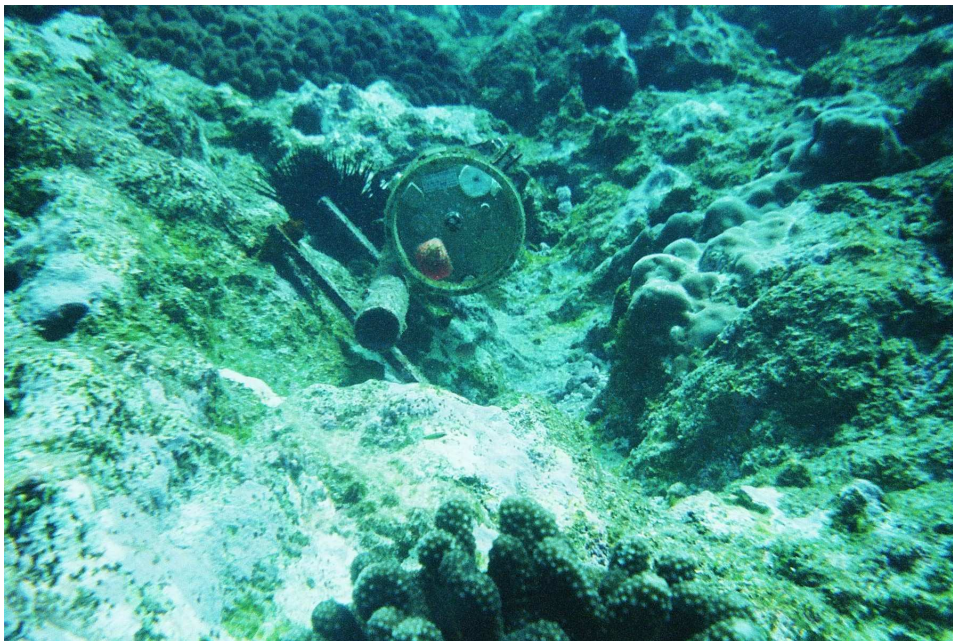
Le marégraphe est fixé dans un canyon du récif frangeant à 9m de profondeur
