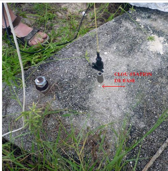
marquage au sol pour notre station GPS de base.
