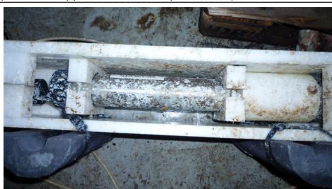
Le RBR après 2 années passées sous l'eau et le sable
