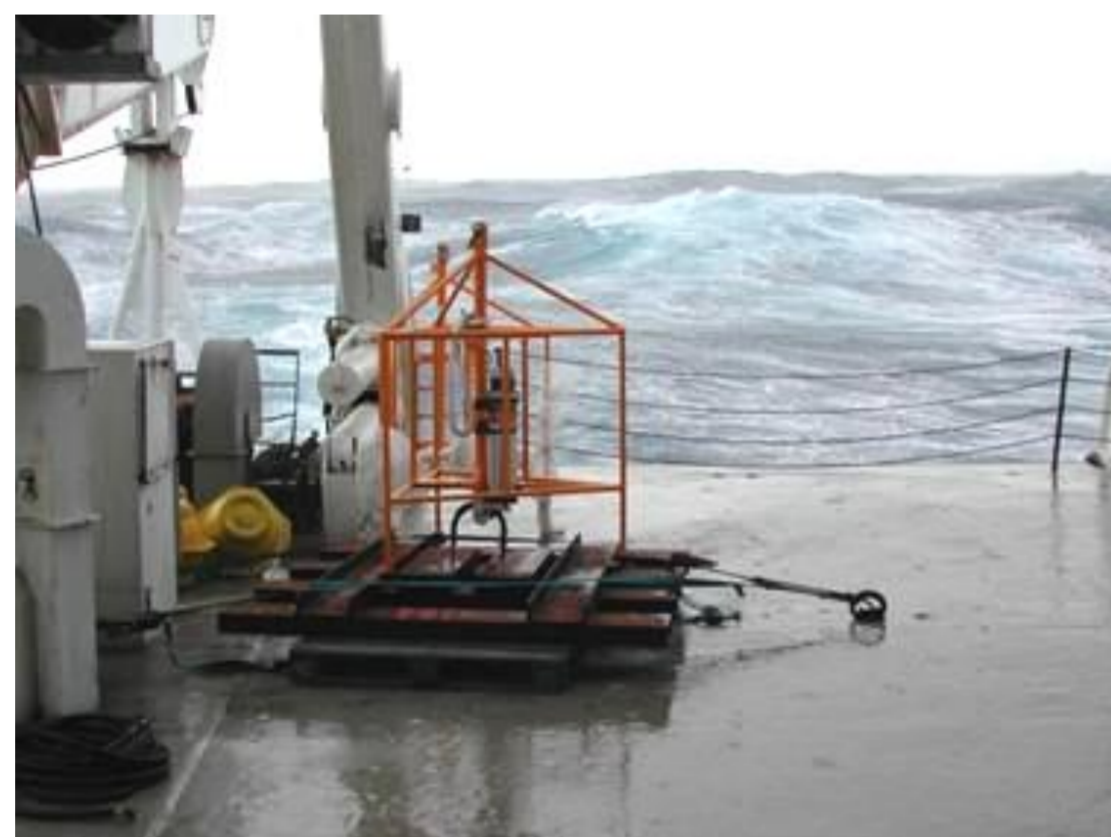
Figure 5. Gauche : Station marégraphique autonome sur le pont du navire Marion-Dufresne en attente d'être mouillée. Droite : Opération de relevage de la station marégraphique à bord du Marion-Dufresne.
