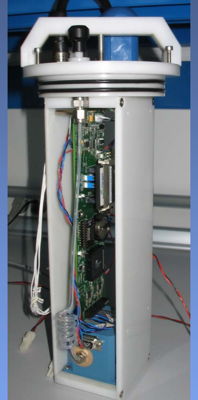
Disposition intérieure du marégraphe DTINSU
