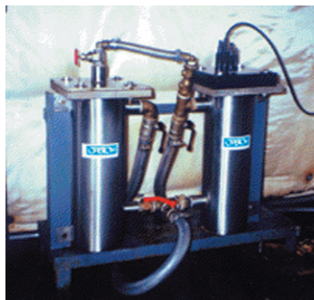
Figure 2 : ThermoSalinoGraphe et son débulleur installés en salle machine sur le circuit de refroidissement du moteur principal.
