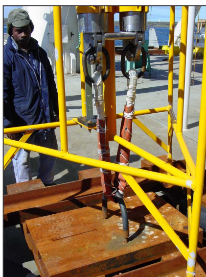
Figure 4 : Système de largage en textile du mouillage CRO02
