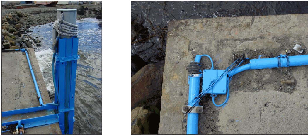
Figure 3 : Marégraphe après une couche de peinture et la jonction à l'angle du quai
