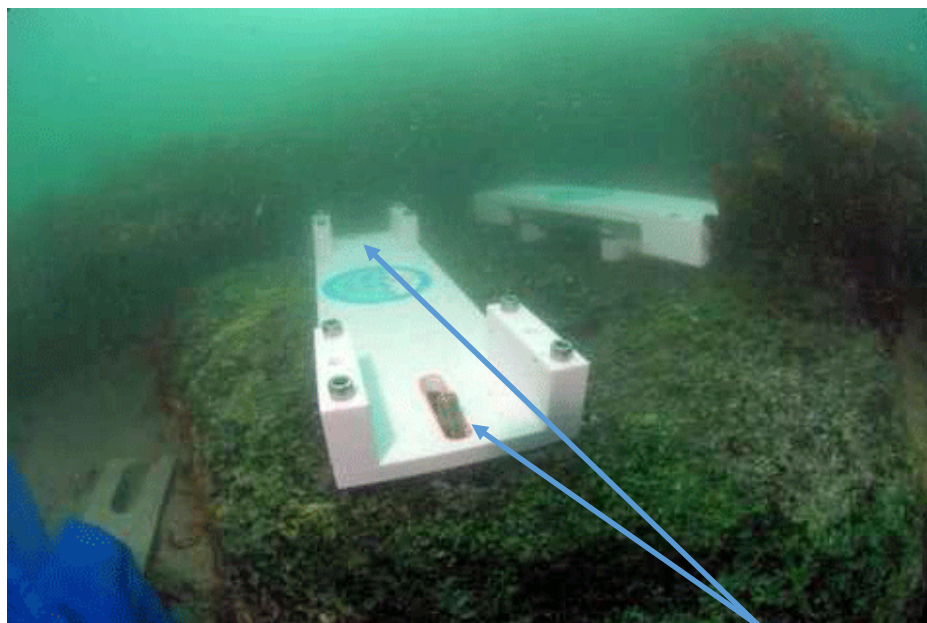
La structure inférieure du marégraphe autonome est fixée sur un rocher avec 2 tiges filetées ancrés dans un rocher et les écrous correspondant (sur la photo, les écrous ne sont pas en place).
