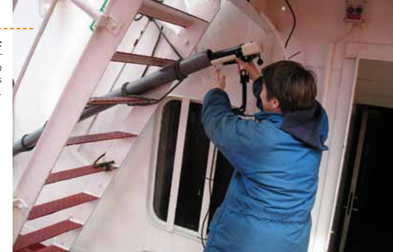
Figure 1c Technique artisanale pour lancer les sondes XBT loin de la coque du navire, dans les conditions de mer forte.
