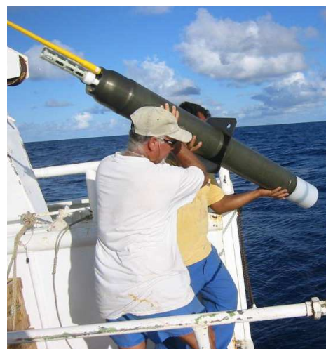
Fig. 3 : Déploiement d'un flotteur PROVOR depuis le pont arrière du navire océanographique Alis lors de la campagne Frontalis-3 dans l'océan Pacifique sud-ouest (©IRD, C. Maes).
