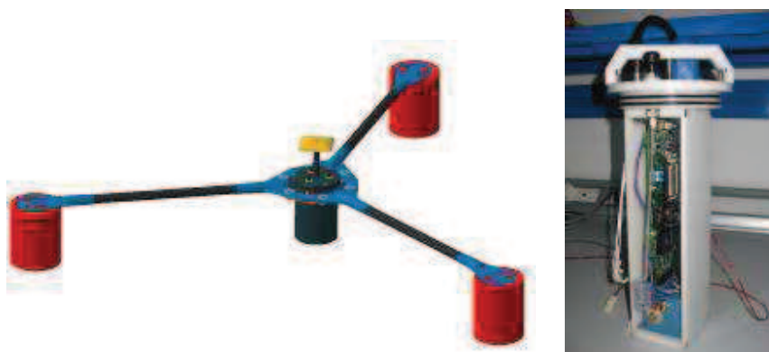
Figure 4 : schéma de la bouée GPS (à gauche) et photo du capteur de pression développé par la DT/INSU
