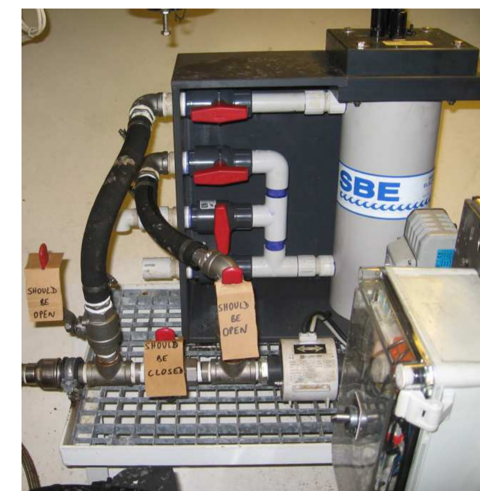
Figure 2. Thermosalinographe du navire Nuka Arctica.
