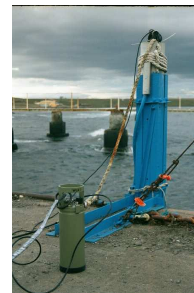
Figure 1. Marégraphe de Kerguelen.
