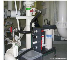
Figure 2. Thermosalinographe en salle des machines.
