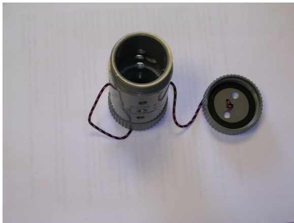
Logement du capteur Onset (Tube PVC avec deux bouchons à vis)
