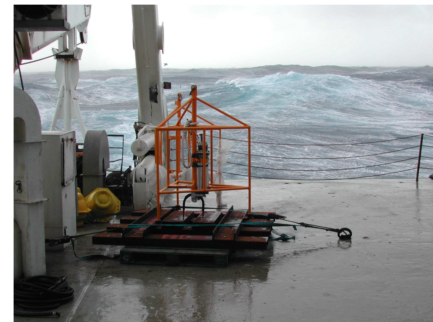
Figure 4. Station marégraphique autonome en attente d'être mouillée, installée à bord du navire Marion Dufresne.
