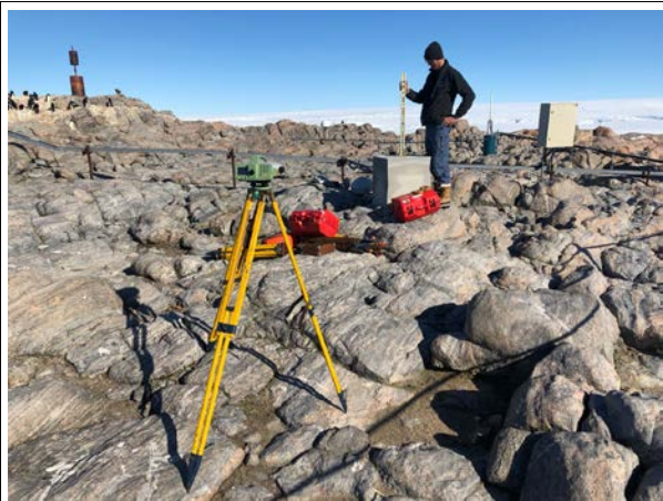
Nivellement direct sur le pilier « DUM2 ».
