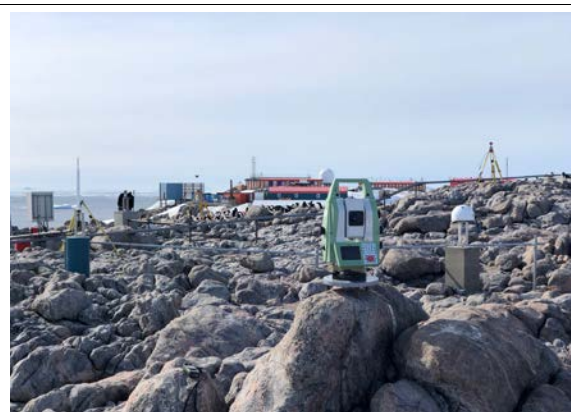
Opérations du rattachement topométrique sur le site de géodésie spatiale.
