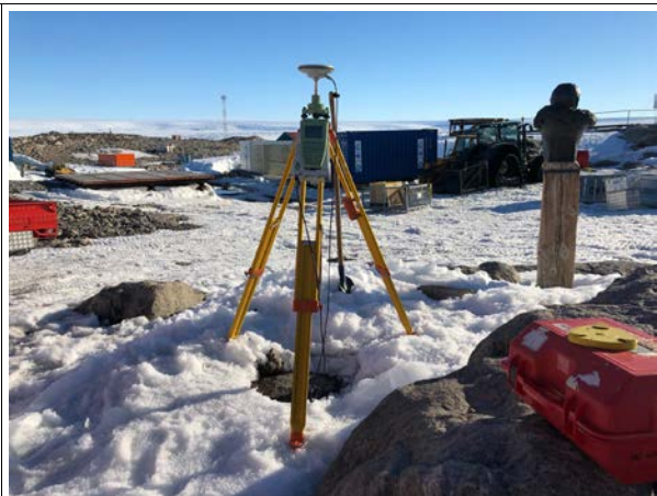
Mesure GNSS sur une borne géodésique
