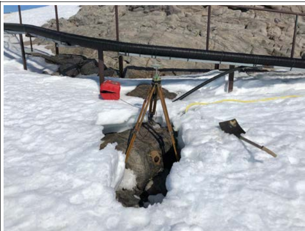
Mesures GNSS sur un repère de nivellement.
