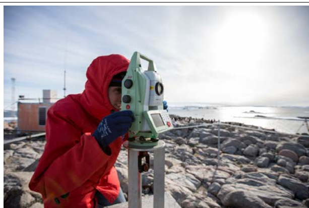
Opérations du rattachement topométrique sur le site de géodésie spatiale.
