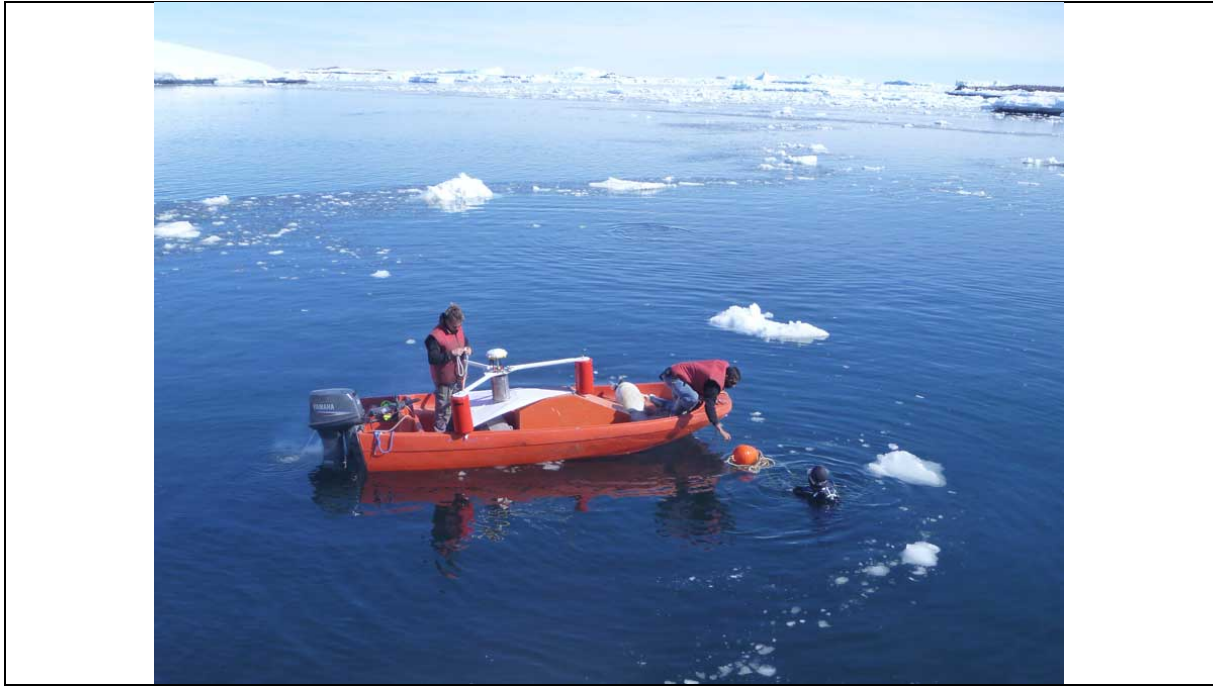
Installation de la bouée GPS au-dessus du marégraphe
