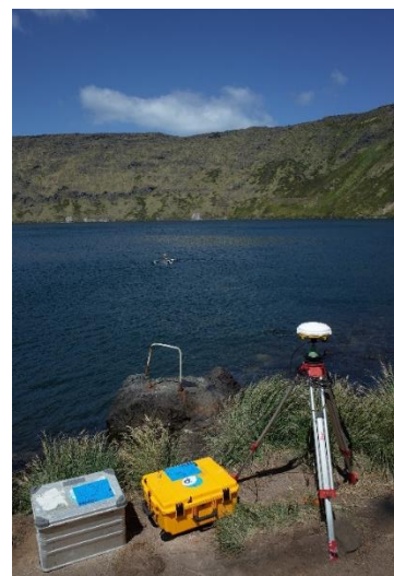
Fig. 2: Station de base installée durant la durée du séjour.
