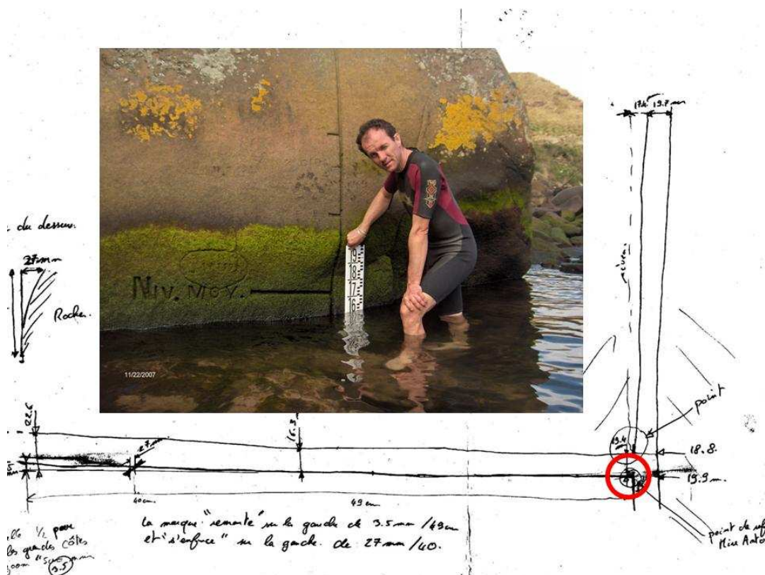
Figure 1: Nivellement par A. Guillot (DT/INSU) de la marque historique de niveau de la mer à Saint-Paul lors de la dernière mission NIVMER. Photo et schéma S. Loyer (CLS).
