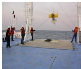
Manœuvre (SEASOAR) à bord du BHO Beautemps-Beaupré et coupes verticales de température et salinité sur le front d'Ouessant effectuée lors de la campagne MOUTON2005.
